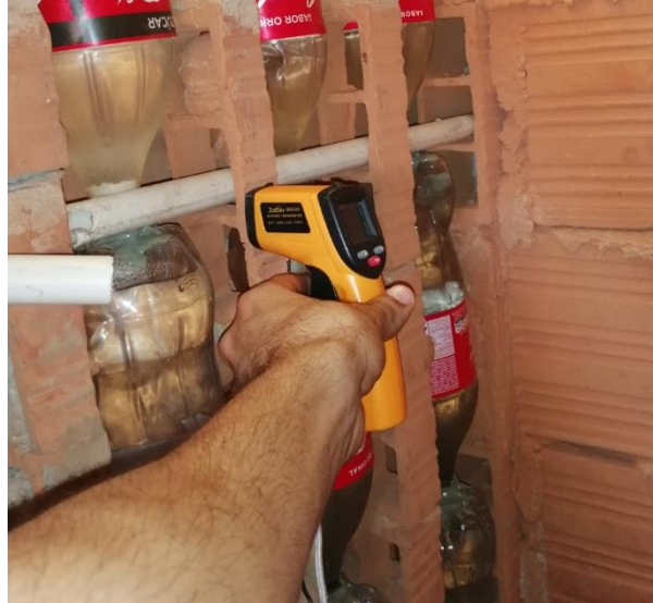
Ilustración 48. Termografía de muro experimental en punto # 10 tomadas con Cámara infrarroja Flir-tg165 día 4 de julio de 2019 a las 10:12 a.m.
