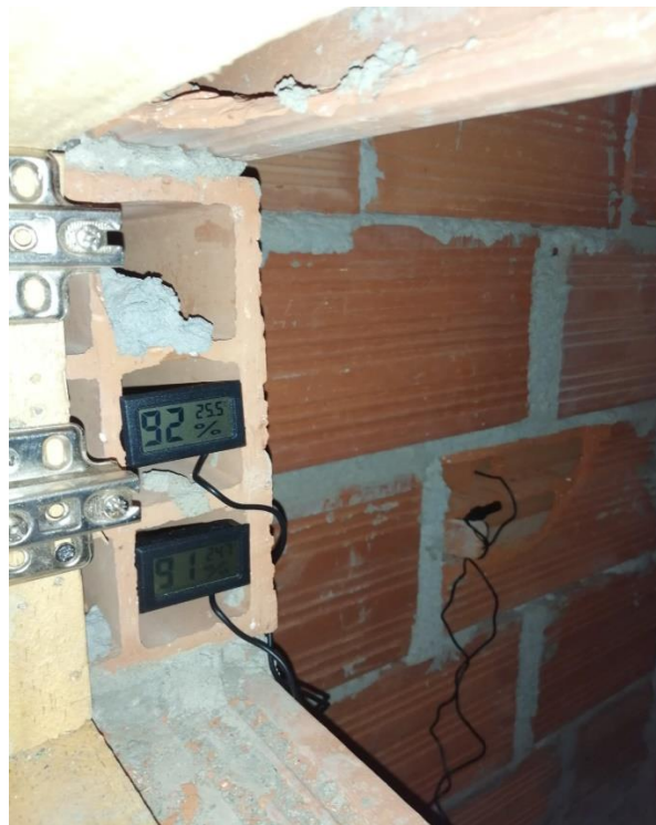
Ilustración 71. Fotografías de ubicación de sensores y pantallas LCD de los termómetros T -318.
