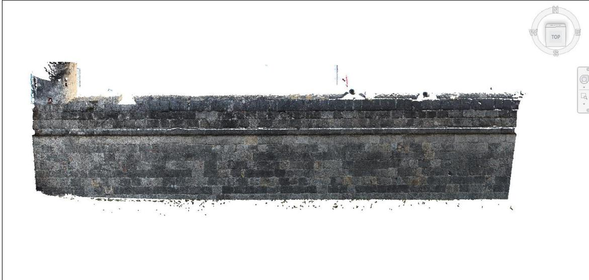
**Figura 45. Modelo resultado del manejo de la nube de puntos en Revit. Fuente: Autores.**
