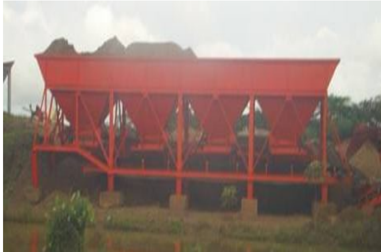
Ilustración 10. Tolvas de agregados en frío
