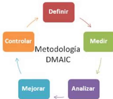
Ilustración 3. Proceso DMAMC. Fuente: Las claves practicas de Seis Sigma, 2ª edición, P. Pande, R. Neuman, y R. Cavanagh.
