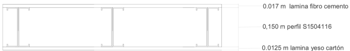
Ilustración 23. Corte entrepiso sistema Steel Framing.
