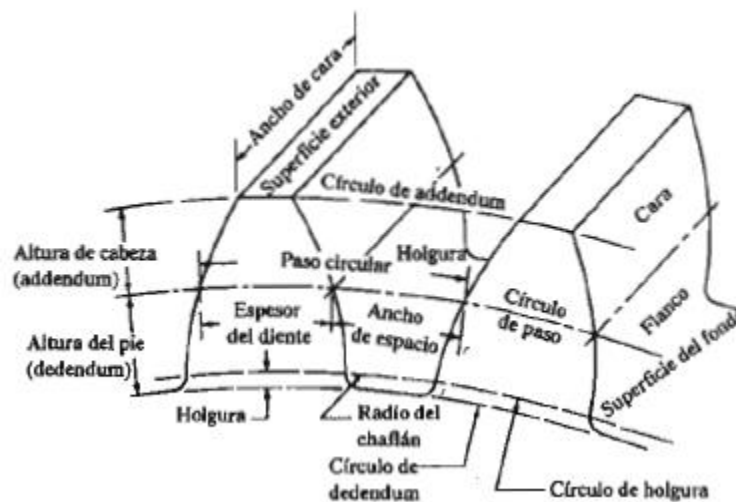
Figura 16: Geometría de un engranaje
