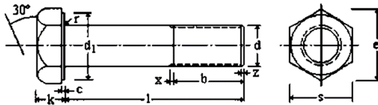
Figura 10: Dimensiones de tornillos de alta resistencia
