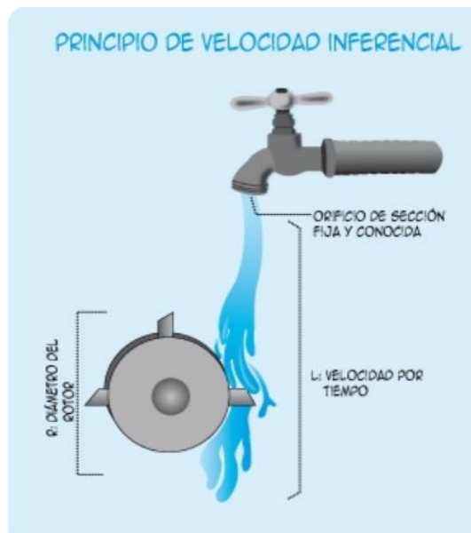
Figura 4. Principio de los medidores tipo turbina.
