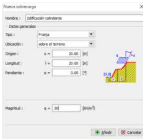
Figura 77. Sobrecarga por edificación colindante. Fuente: Autor.
