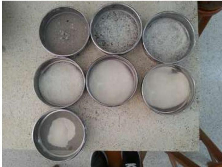
*Ilustración 15 Material retenido por tamices Fuente: Autores*
