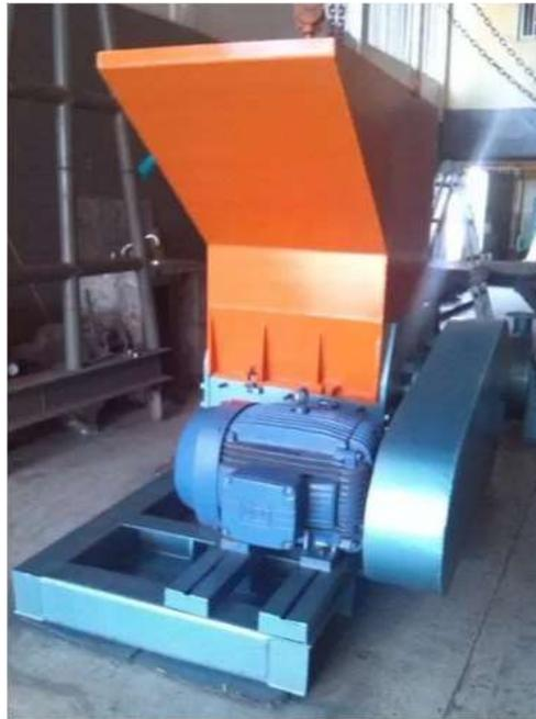
*Ilustración 22 Molino Marca M.I.V Modelo MP60-800 Motor de 60Hp. Fuente: MIV. C.A.*
