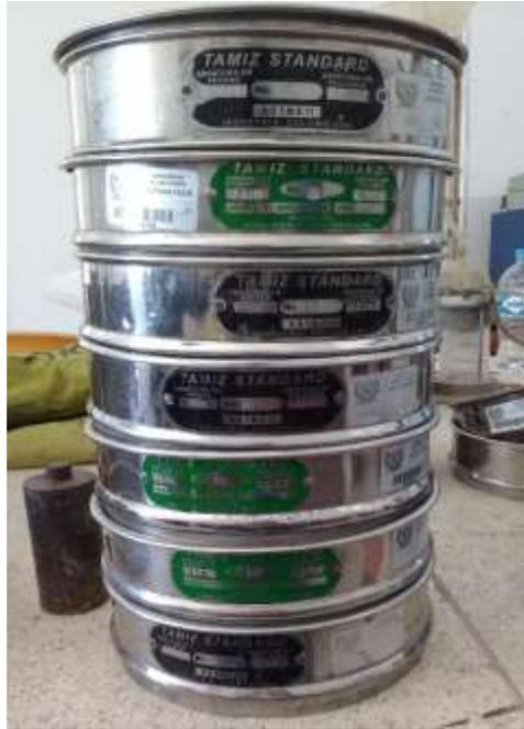
*Ilustración 10 Serie de tamices granulométrica Fuente: Autores*
