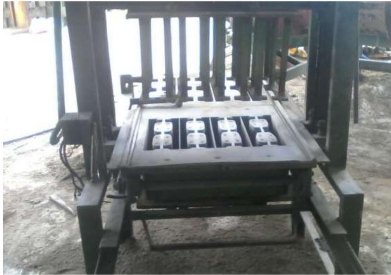
*Ilustración 4* Máquina de fabricación de bloques vibrados *Fuente:* Autores
