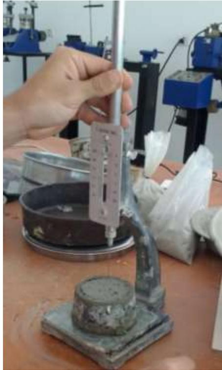
*Ilustración 9 Montaje del ensayo de Tiempo de fraguado Fuente: Autores*
