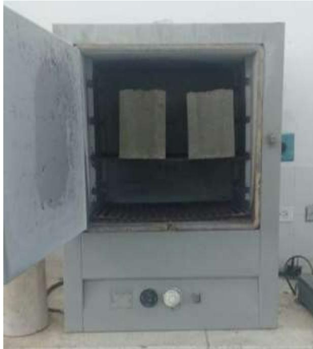
*Ilustración 20 Secado al horno de los bloques Fuente: Autores*
