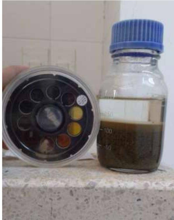
*Ilustración 12 Ensayo de contenido de materia orgánica Fuente: Autores*
