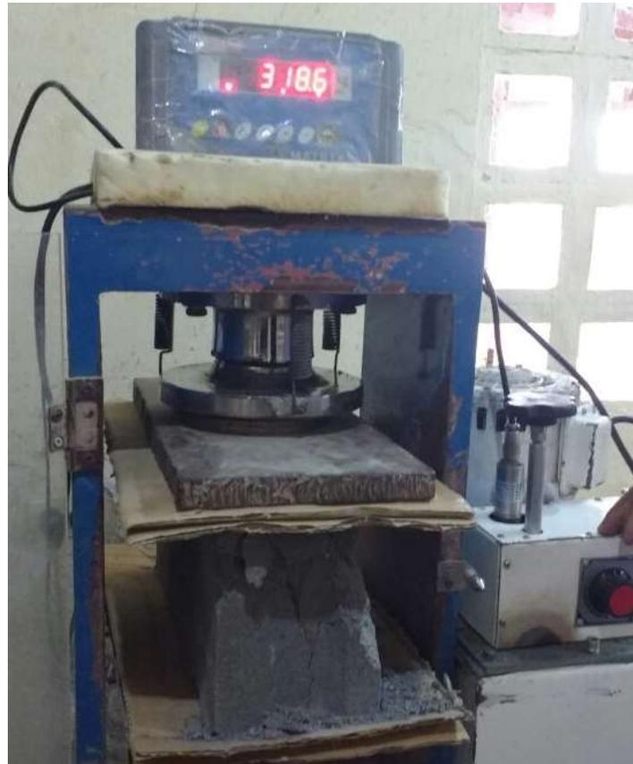
*Ilustración 19 Rotura de uno de los bloques Fuente: Autores*
