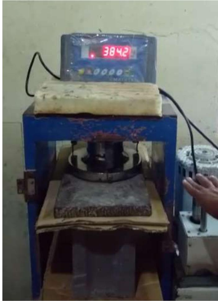
*Ilustración 18 Montaje del ensayo de resistencia a la compresión. Fuente: Autores.*
