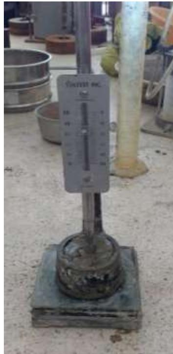
*Ilustración 8 Montaje del ensayo de Consistencia normal Fuente: Autores*
