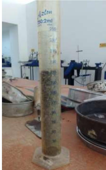
*Ilustración 11 Ensayo volumen de arena Fuente: Autores*
