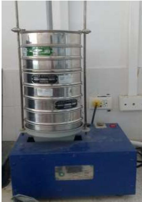
*Ilustración 14 Serie de tamices para granulometría y maquina tamizadora. Fuente: Autores*
