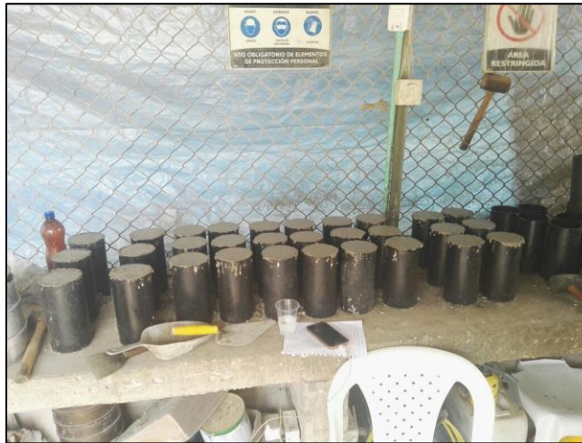
Figura 7. Probetas de concreto para ensayos a la compresión
