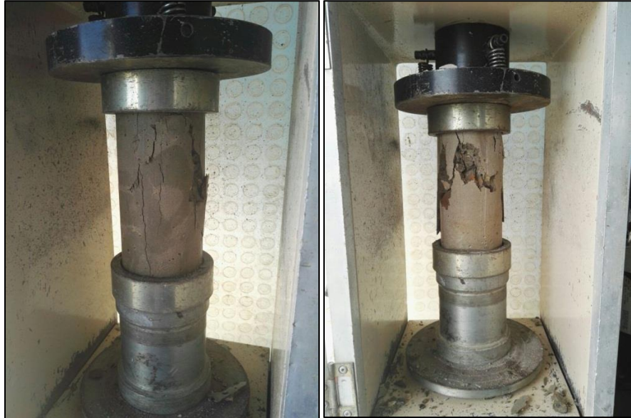
Figura 8. Ensayo a la compresión del concreto.
