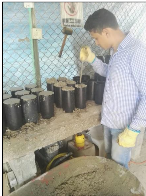
Figura 6. Elaboración de las probetas de concreto.
