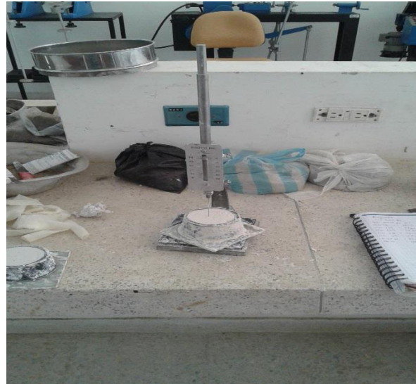
Figura 3. Correspondiente a los ensayos de tiempo de fraguado con Cal Viva (Aguja 1mm). Fuente: Autor
