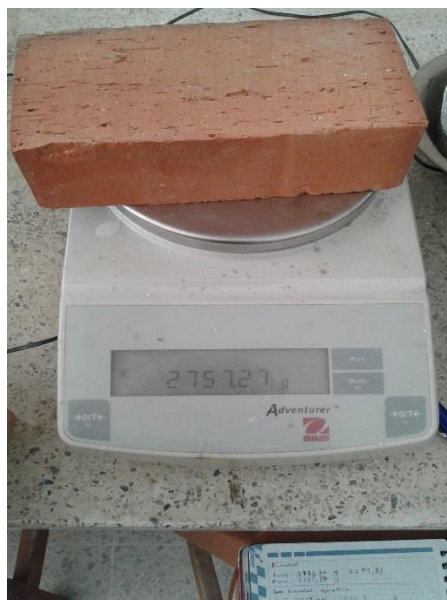
Figura 4. Correspondiente a los ensayos de Gravedad Específica Bulk y Absorción.
