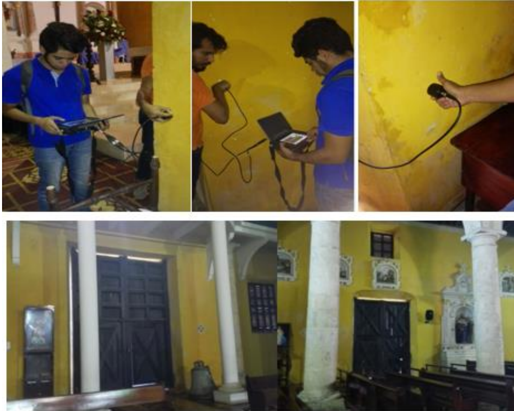
Figura 16. Correspondiente al proceso de realización de los ensayos ultrasónicos.
