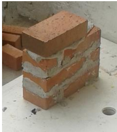
Figura 6. Correspondiente al proceso constructivo de los muretes.
