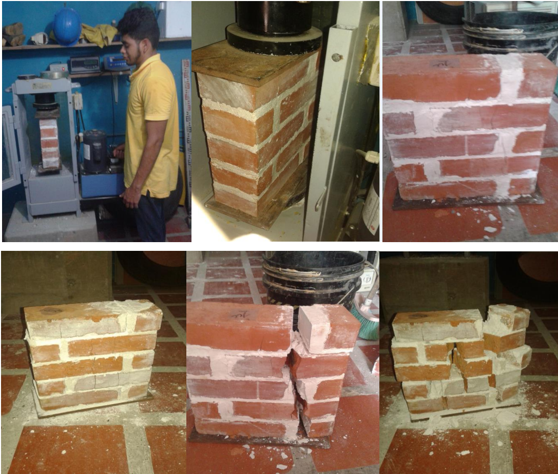
Figura 7. Correspondiente al proceso de ensayos a los muretes.
