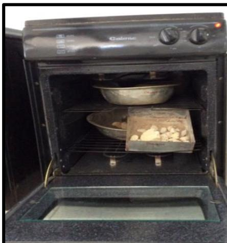
**Ilustración 26.** Equipo usado para el secado de las muestras durante el ensayo a humedad. **FUENTE:** (Los Autores, 2015)
