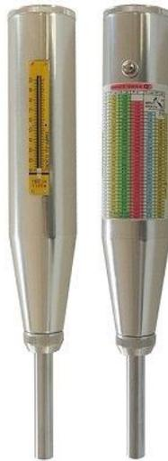
Ilustración 4. Esclerómetro (Martillo de Schmidt)
