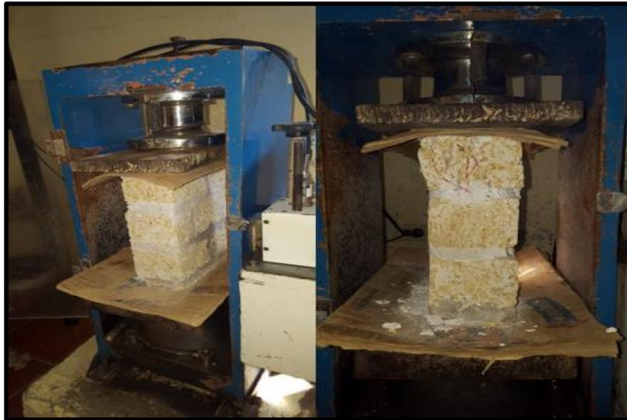
*Ilustración 22. Ensayo a Compresión de Muretes. FUENTE: (Autores, 2015)*
