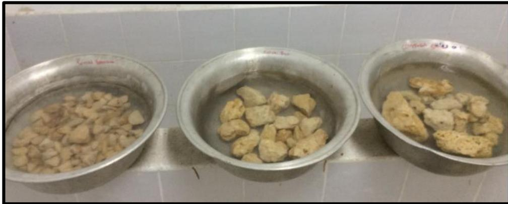
*Ilustración 17. Muestras Sumergidas para cálculo de Porosidad. FUENTE: (Los Autores, 2015)*
