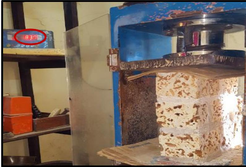
*Ilustración 27. Murete de Coloncito (después de fallar). FUENTE: (Autores, 2015)*
