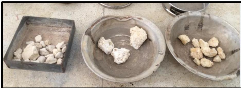
*Ilustración 18. Muestra seca para ensayo de humedad natural. FUENTE:(Los Autores 2015)*
