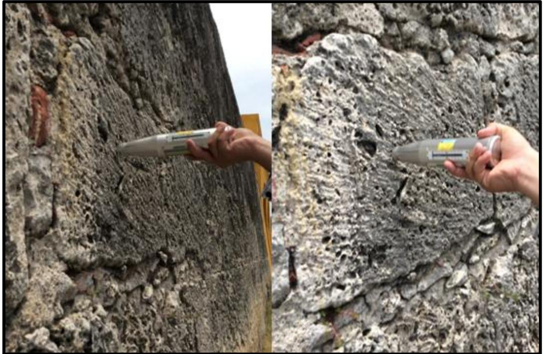
Ilustración 24. Ensayo de Martillo de Rebote en el Tramo. FUENTE: (Los Autores, 2015)
