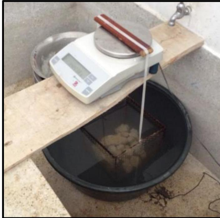
*Ilustración 15. Pesaje de Muestra Sumergida. FUENTE: (Los Autores, 2015)*
