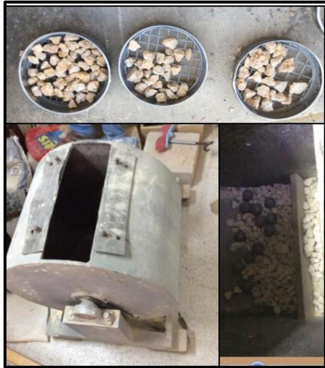
*Ilustración 16. Ensayo Desgaste Máquina de los ángeles. FUENTE: (Los Autores, 2015)*
